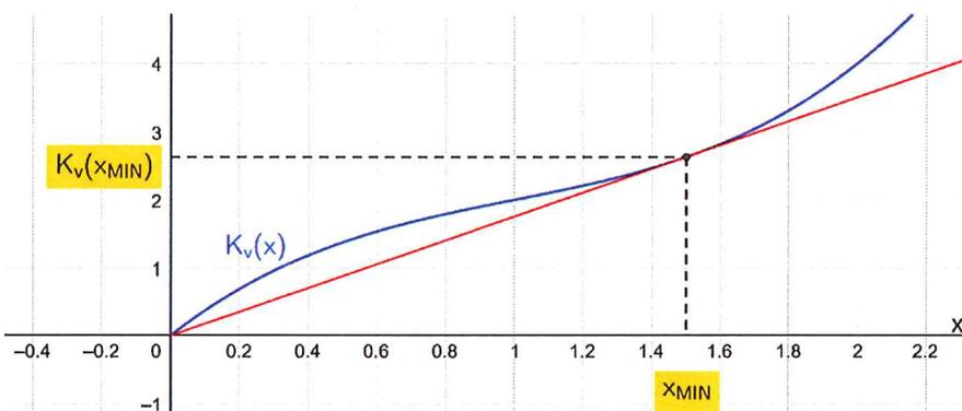
Lege eine Gerade ausgehend vom Ursprung so an den Graphen der variablen Kostenfunktion, dass die Gerade den Graphen in genau einem Punkt berührt. Die Stelle des Berührungspunktes ist das **Betriebsminimum  $x_{MIN}$** .
