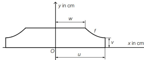
Ein Teil der Begrenzungslinie des Querschnitts kann durch den Graphen der quadratischen Funktion  $f$  mit  $f(x) = a \cdot x^2 + b \cdot x + c$  modelliert werden.
